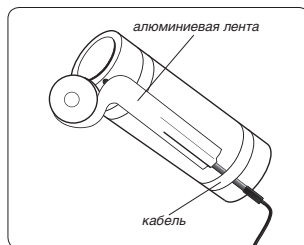
Рис. 3. Проклейка кабеля алюминиевой лентой для лучшего распределения тепла
