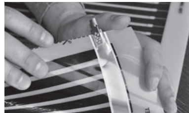
Рис. 5. Установленный на термопленку контактный зажим
