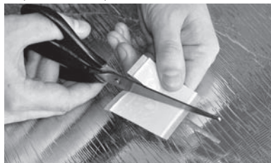
Рис. 7. Разрезание битумной изоляции на 2 части
