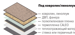
Рис. Схема монтажа теплого пола CALEO под ковролин или линолеум
