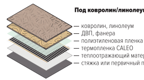
Рис. Схема монтажа теплого пола CALEO под ковролин или линолеум
